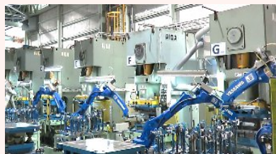
ロボット自働搬送プレスライン
